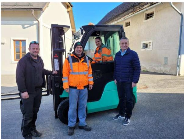
Für den Bauhof wurde erstmalig ein gebrauchter Gabelstapler mit 7800 Betriebsstunden, 50 PS/37 KW, Diesel von Firma STS Stapler-Technik Gerhard Moser aus Pöchlarn angekauft. Es handelt sich um einen Stapler mit voll geschlossener beheizter Kabine. Die Hubkraft beträgt zwischen 1500 - 3000 kg. Die Hubhöhe beträgt 2100 mm.
